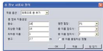
[층정보 입력창을 이용한 층 자동 생성]
